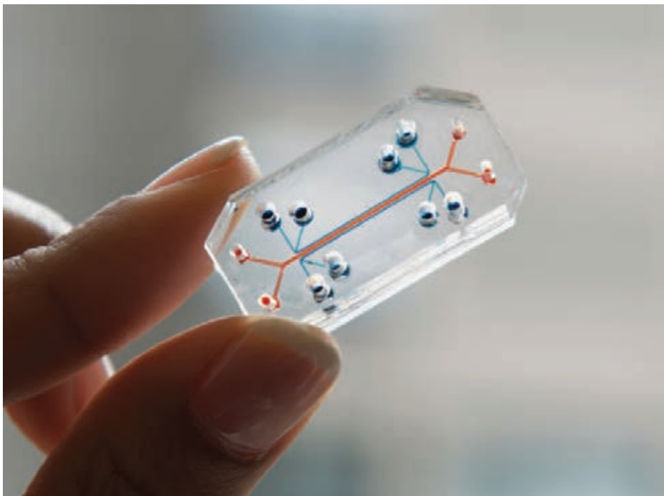
Формирование легкого: когда этот чип имитирует процесс дыхания, при котором давление воздуха на клетки то повышается, то падает, из кровеносных сосудов и клеток легких образуются сложные легочные структуры
