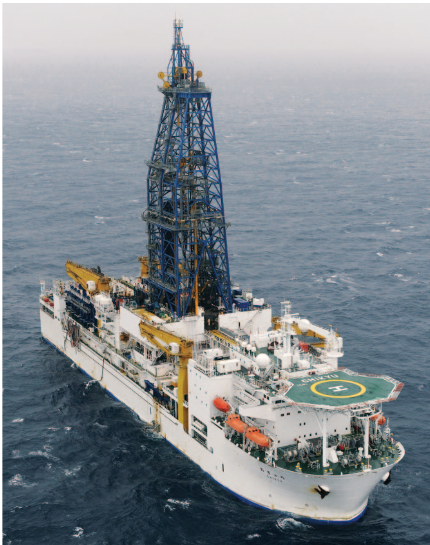
Японское судно Chikyū готовится к бурению гидратов метана в донных отложениях на глубине 1 тыс. м в Тихом океане
